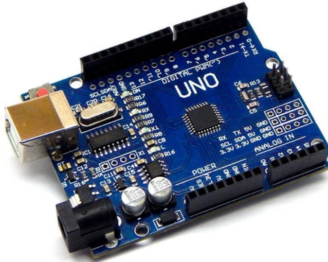
Рисунок 2.9. Зовнішній вигляд контролера «Arduino UNO»
