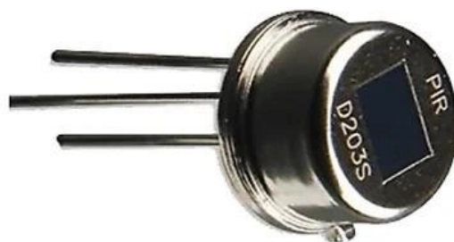
Рисунок 2.10. Зовнішній вигляд датчика руху D203S
