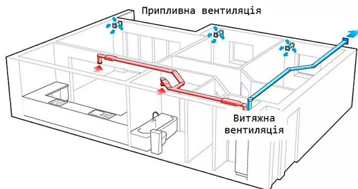
Рис. 7.2.1 Вентиляція механічна припливно-витяжна [24]
