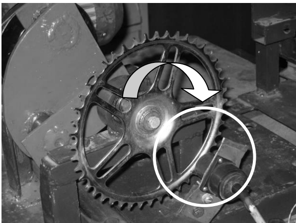
Рис. 5. Розташування датчика вимірювання кутової швидкості обертання привідного вала ДЧВ-1
