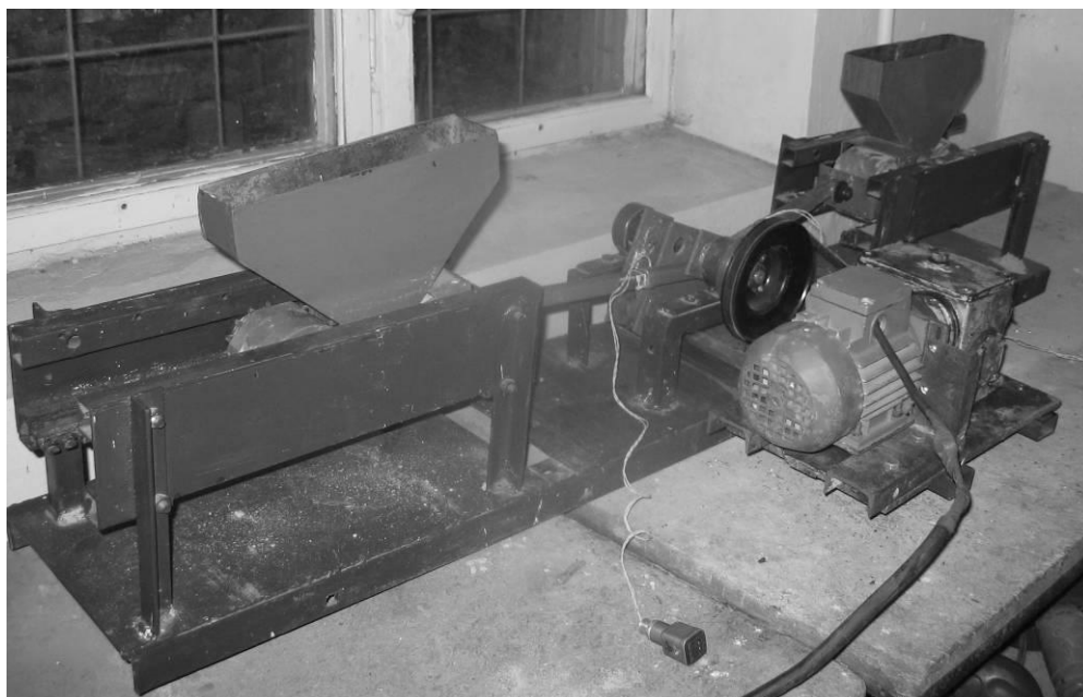
Рис. 1. Фізична модель роликової формувальної установки з рекуперативним приводом
