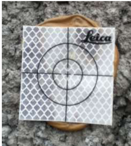
Рис. 3.2 Рефлекторна марка та спосіб її закріплення
