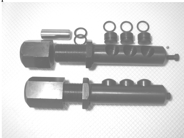
Рис.1. Портативний гідропоршневий агрегат для розколу гранітних блоків
