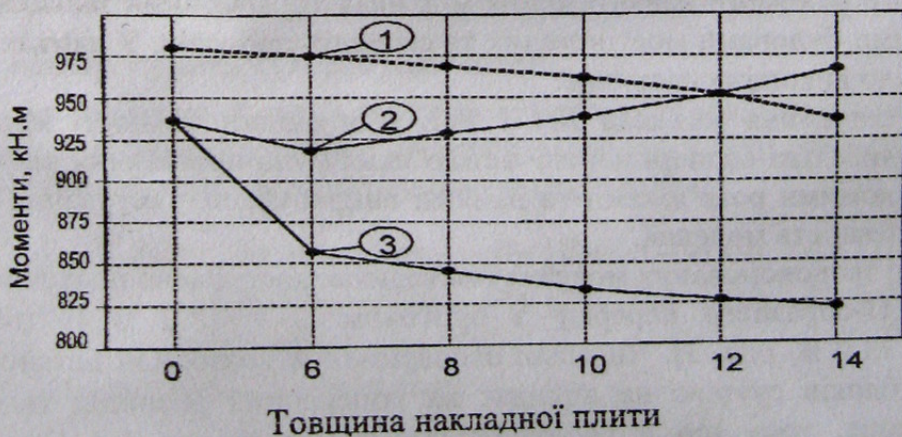
Рис. 5. Зміна згинаючих моментів із збільшенням товщини накладної плити 1 - несуча здатність балки; 2 - зміна моментів з урахуванням власної ваги плити; 3 - зміна моментів без урахування власної ваги плити.
