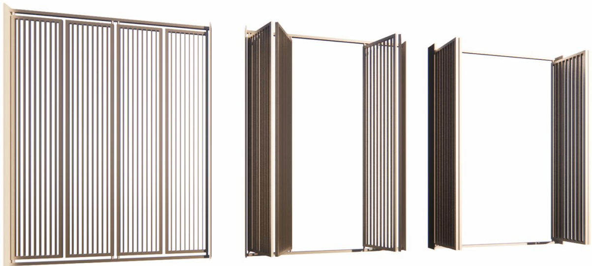
Рис. 3.19. 3D-модель елемента динамічного фасаду (повністю закриті ролети, напівзакриті й відкриті)
