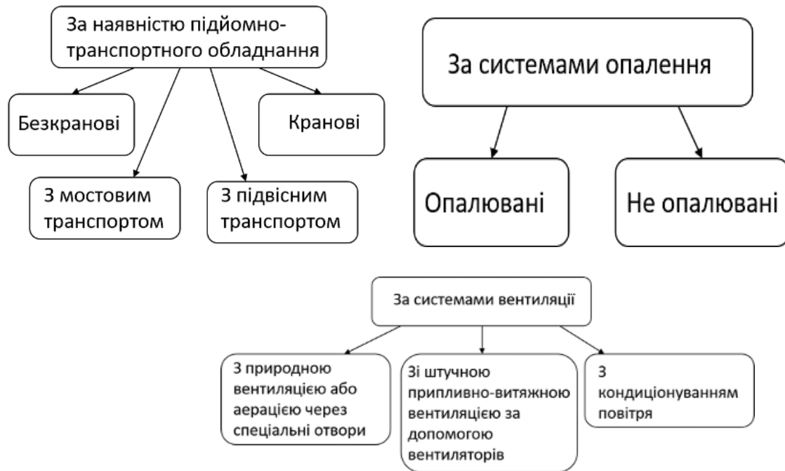
Рис.2.3. Класифікація промислових будівель за окремими інженерними позиціями (Розроблено автором на основі матеріалів [4.с 61-71])
