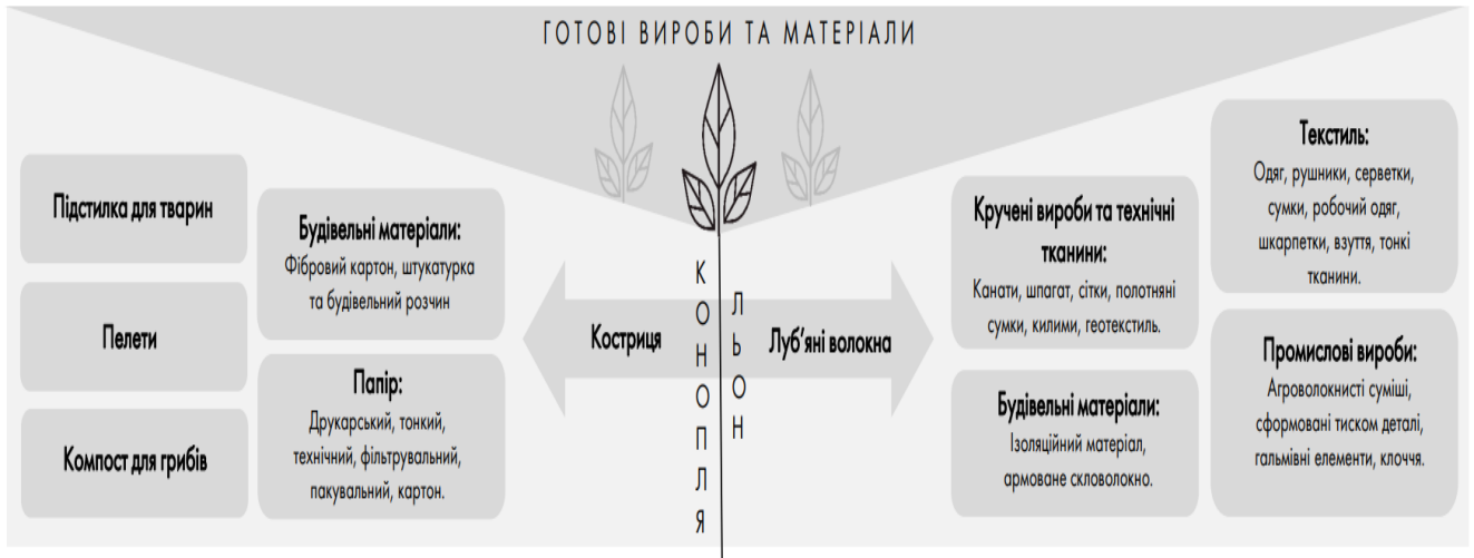
Рис. 2.11. Готові вироби й матеріали виробничого комплексу з переробки луб'яних культур (авторська розробка)
