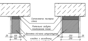
Кріплення перегородки (100,120,250) до стіни
