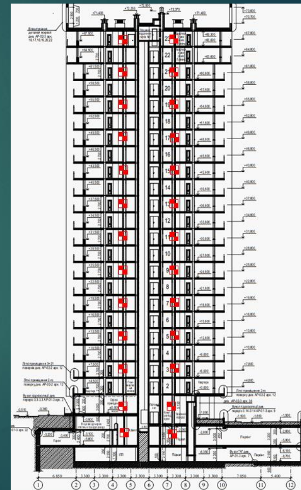
Схема закріплення датчиків на несучих конструкціях будівлі
