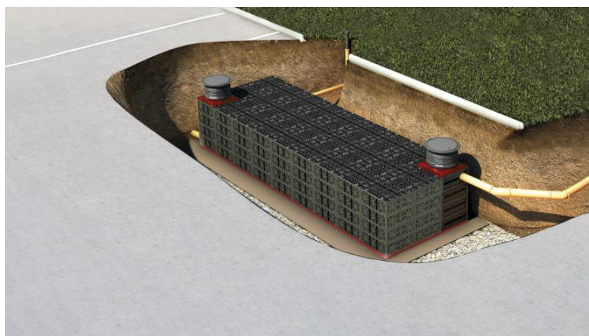
Ри.6.1. Встановлення дренажних блоків
