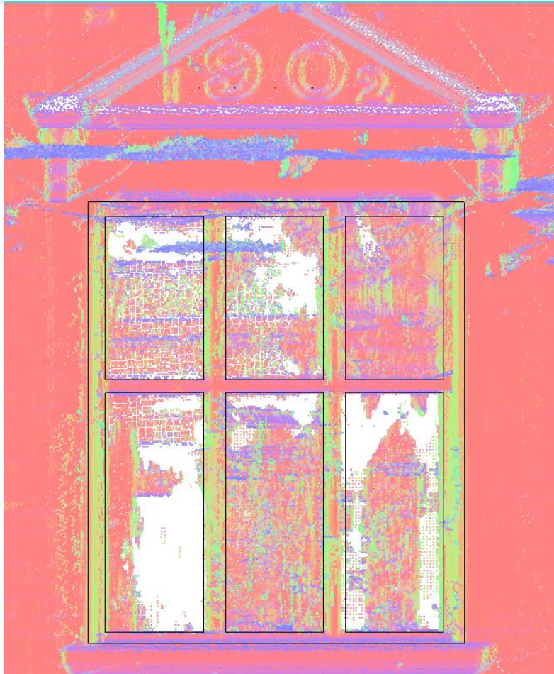
Моделювання вікна та підвіконня по хмарі точок
