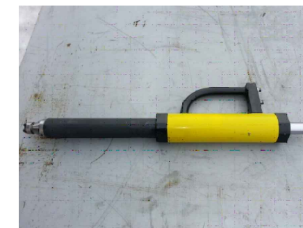
Домкрат для попереднього напруження арматури
