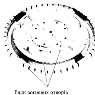
Рис 2.5. Зовнішній вигляд пальника з трьома рядами вогневих отворів, виробник Sabaf (Італія)
