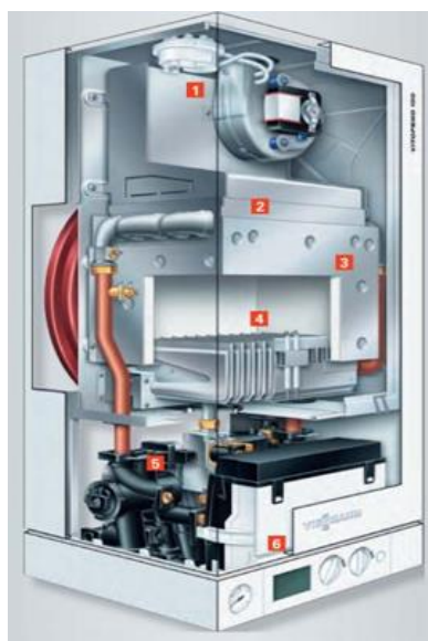
Рис. 1.3. Конструкція традиційного комбінованого котла Viessmann Vitopend 100, що працює на газовому паливі: 1 – димосос, 2 – теплообмінник, 3 – камера згоряння, 4 – модульний палиник, 5 – гідравлічний модуль, 6 – панель керування
