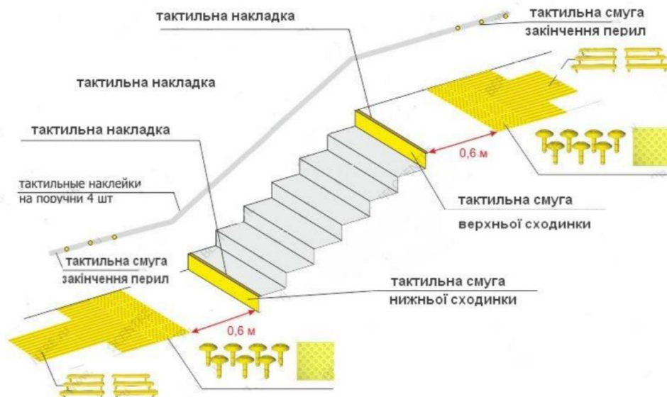
Рис.2.10. Облаштування сходового маршу – контрастною розміткою
