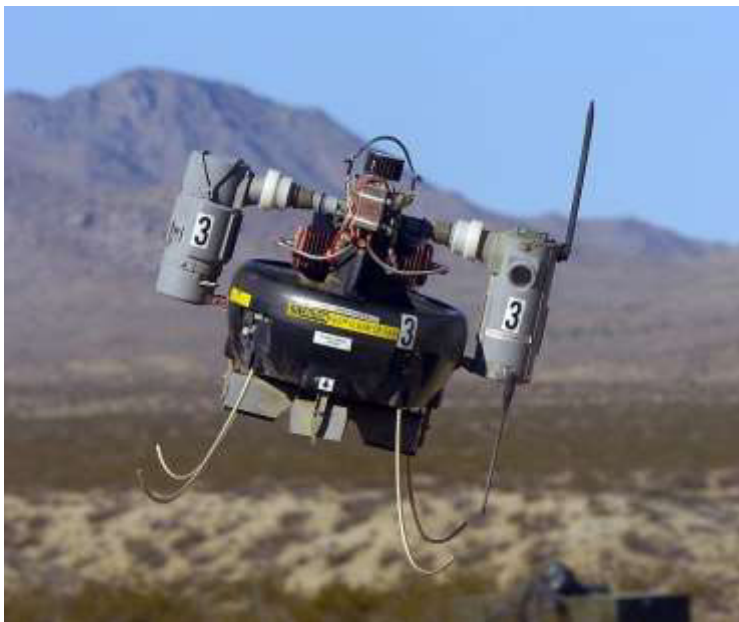
Рис. 2.13 Мікро- літальний апарат (мікро-БПЛА, MAV) , призначений для перенесення систем відео- та фотозйомки
