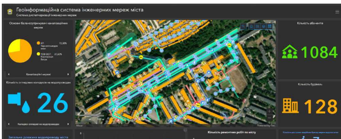
Рис. 1.6 Підсистема оперативного диспетчерського моніторингу стану інженерних мереж
