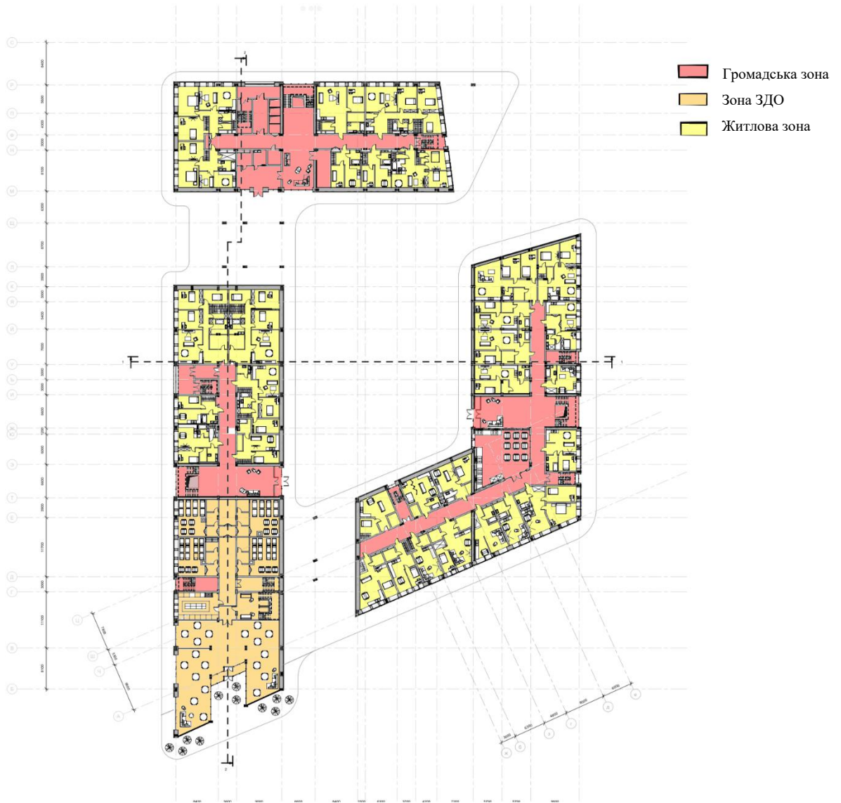
Рис. 4.2.2 Схема зонування житлового блоку, типовий поверх
