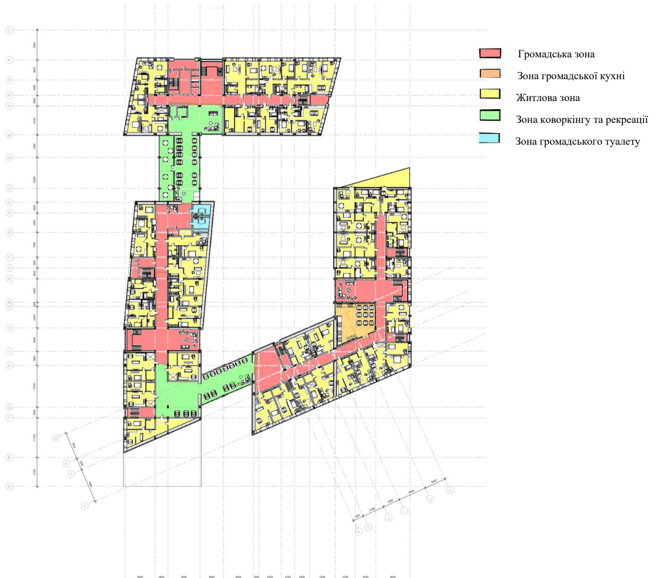
Рис. 4.2.3 Схема зонування житлового блоку, поверх із зонами коворкінгу та рекреації
