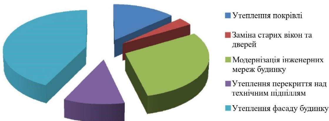
Рис. 3.7 Діаграма витрат на тепло модернізацію за видами виконаних робіт.
