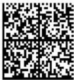
Рис. 10.6. Приклад 2D штрих-кової символіки DataMatrix
