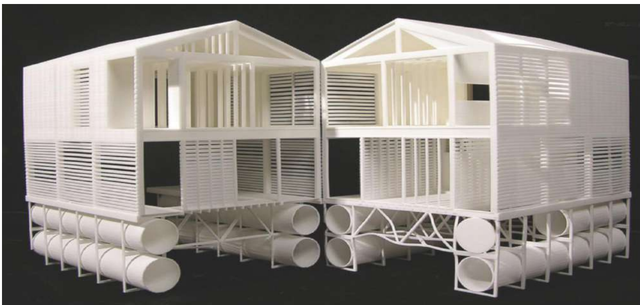
Рис. 2.37 Конструктивна схема плавучого будинку на сталевих понтонах
