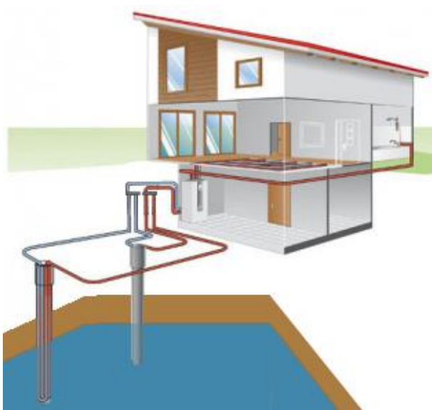
Рис. 3.15. Тепловий насос «вода – вода»
