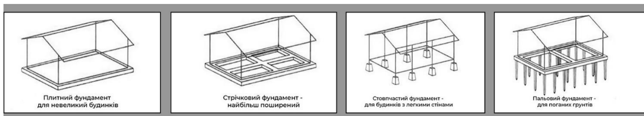
Рис. 2.7. Конструктивні рішення фундаментів
