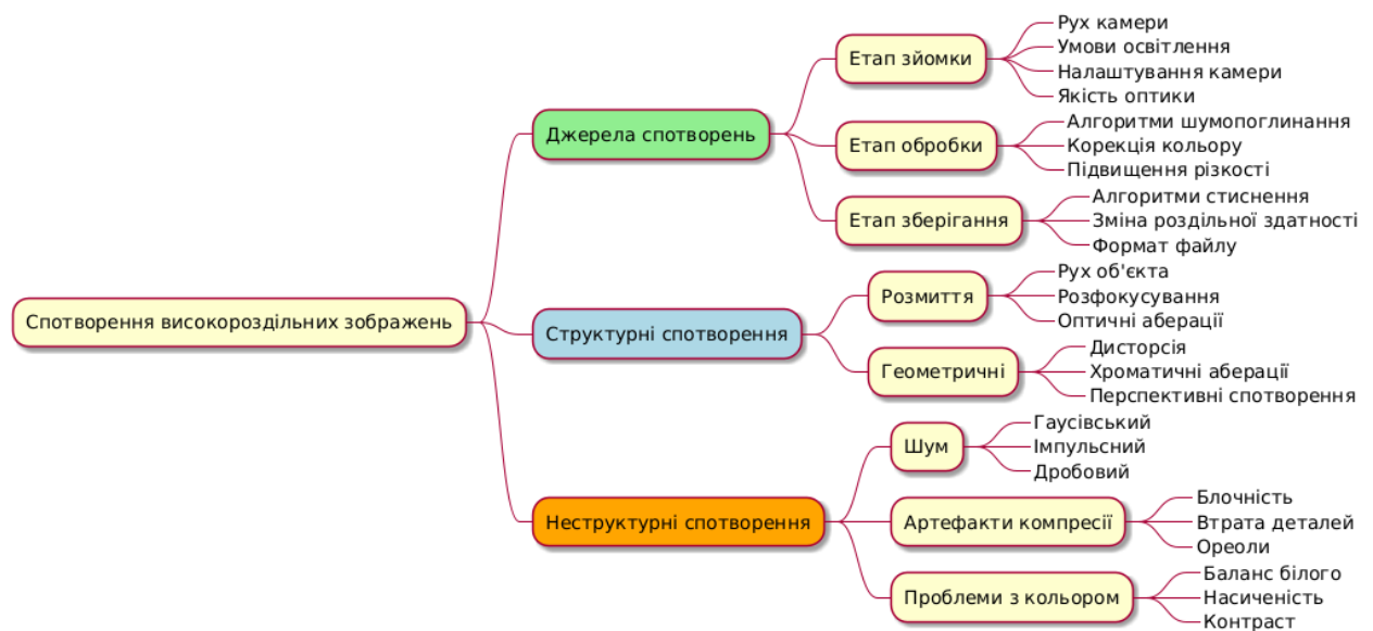
Рисунок 2.3 – Схема взаємозв'язків між типами спотворень та їх джерелами для зображень високої роздільної здатності
