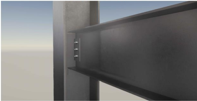
Вузел примикання другорядних балок до колони
