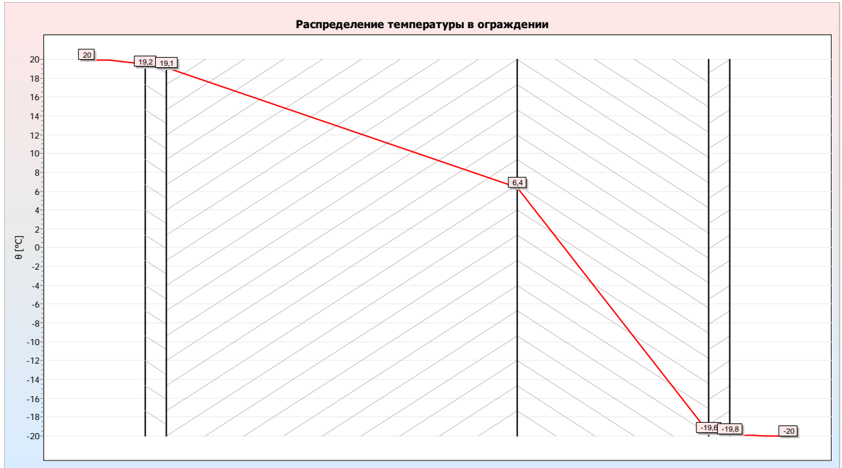
Рис.2.1. Розподіл температур в зовнішній стіні житлового будинку
