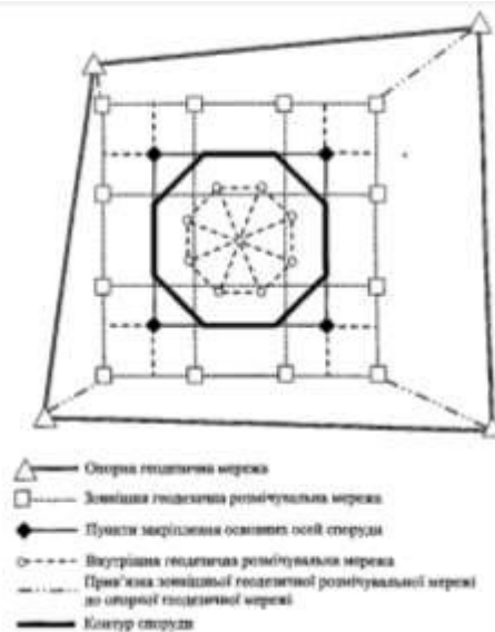
Рис. 1.1. Типова схеми геодезичної розмічувальної мережі
