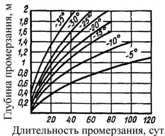
Рис. 1. Зависимость глубины промерзания грунтов от продолжительности промерзания и температуры воздуха
