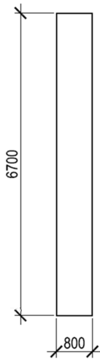
Рис. 4.17 Геометричні розміри прямокутної барети (тип 2)
