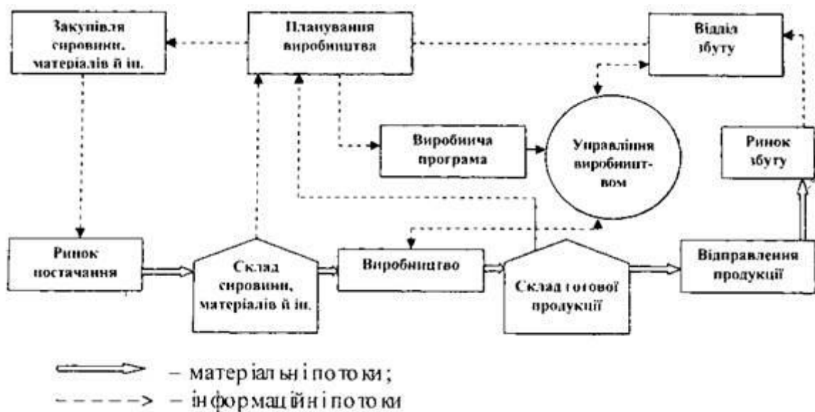
Рис. 3.2. Схема внутрішньо виробничої логістичної системи у взаємозв'язку з ринком постачальників і ринком споживачів [31]
