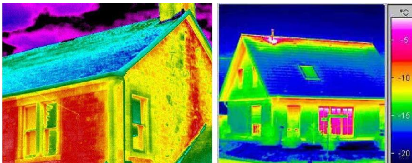
Рисунок 3.3 – Термограми індивідуальних будинків із різним рівнем теплозахисту
