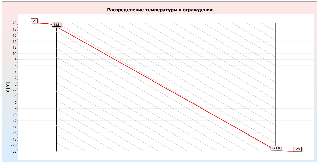
Рис.2.1. Розподіл температур в конструкції зовнішньої стіни СТО [7]
