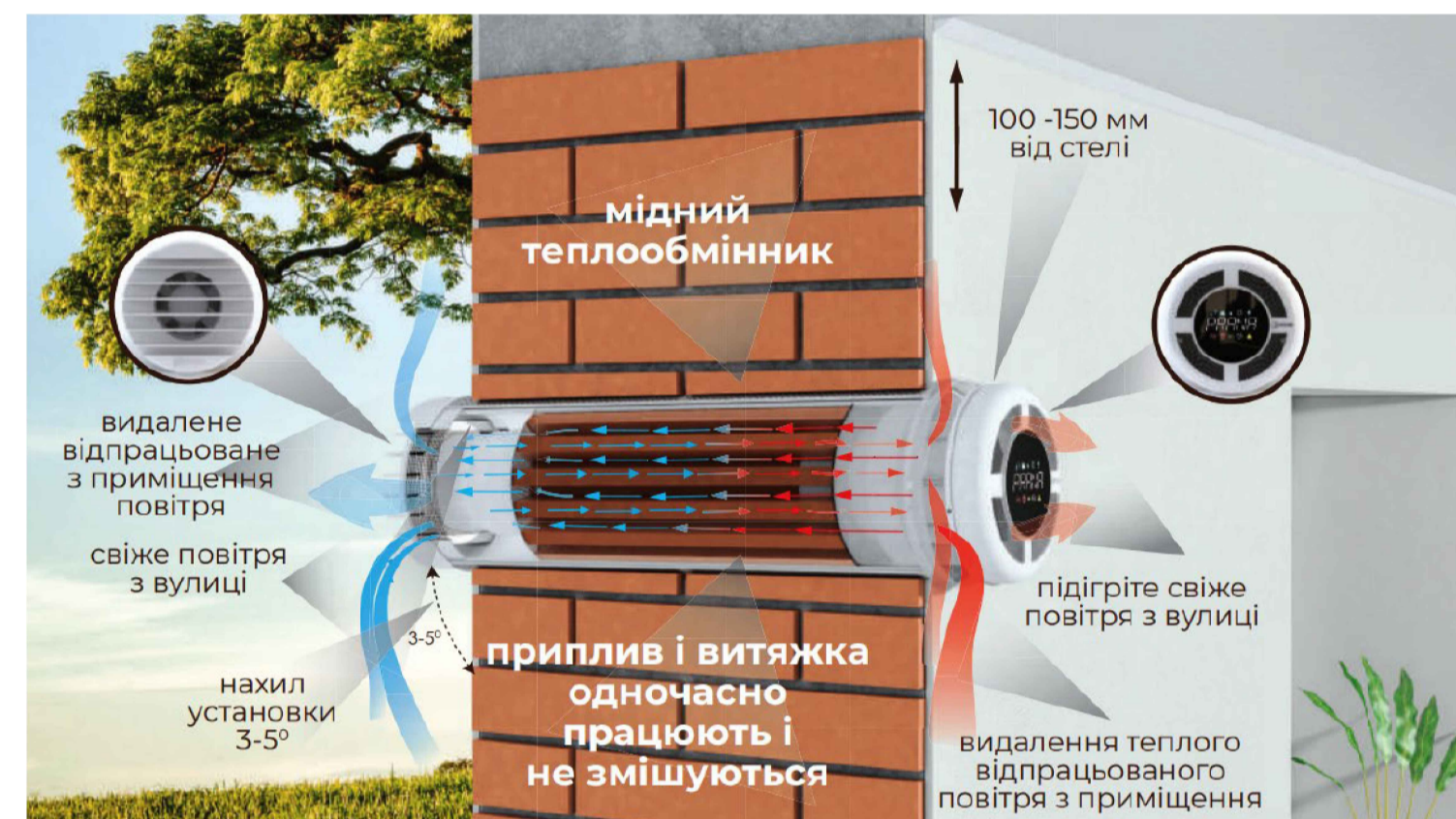
Рис. Влаштування рекуператора в конструкції стіни
