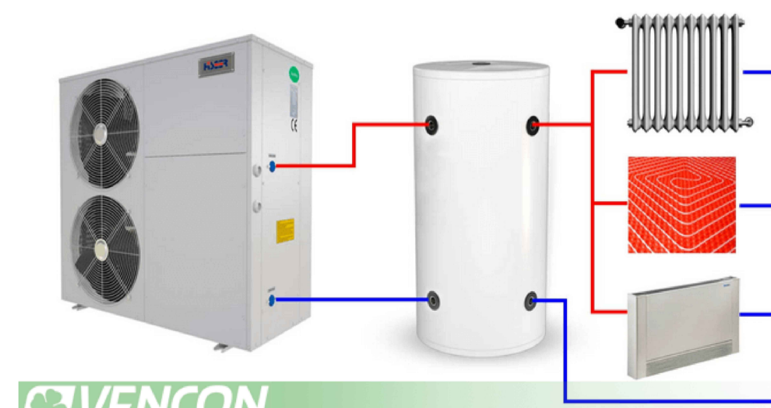
Рис. Принцип дії теплового насоса
