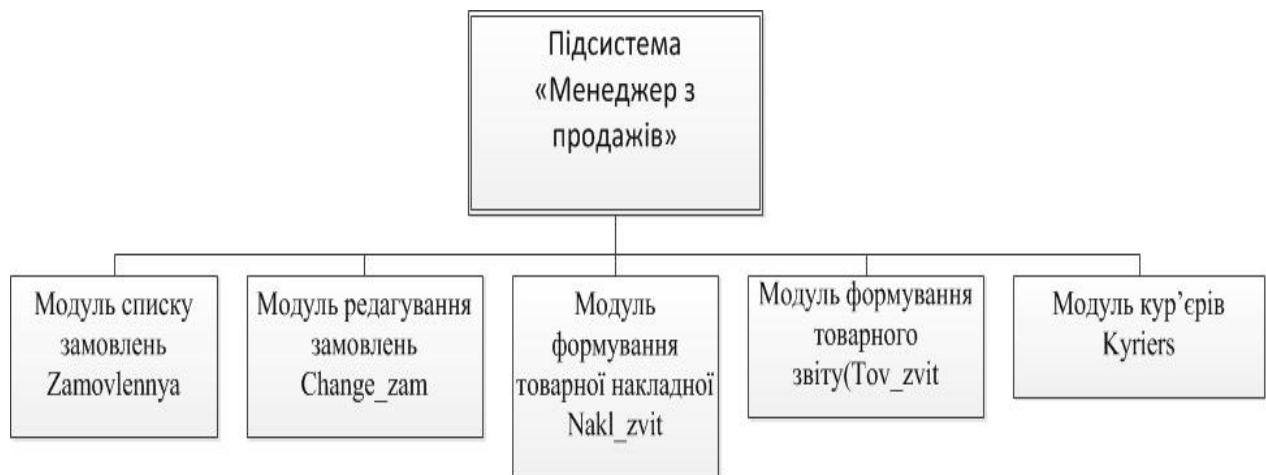
Рисунок 3.8 Структурна схема модулів підсистеми «Менеджер з продажів»
