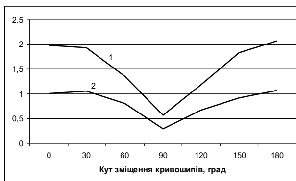
Рисунок 4. Графіки зміни відносних коефіцієнтів \varepsilon_1 та \varepsilon_2 в залежності від кута зміщення кривошипів
