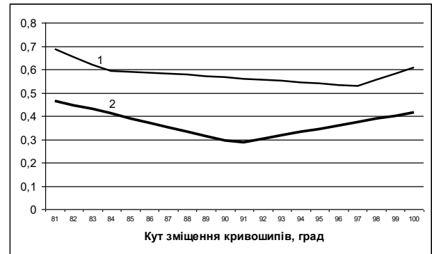
Рисунок 6. Графіки зміни відносних коефіцієнтів \varepsilon_1 та \varepsilon_2 в залежності від кута зміщення кривошипів в межах від \Delta\varphi = 81^\circ до \Delta\varphi = 100^\circ
