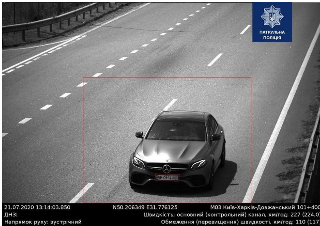
Рисунок 1.2. Приклад фото порушника ПДР з розпізнаванням державного номерного знаку
