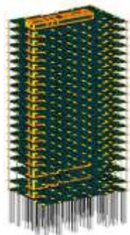
Рисунок 1. Розрахунково-аналітична модель будівлі у ПК Ліра-САПФІР 2024 [2]
