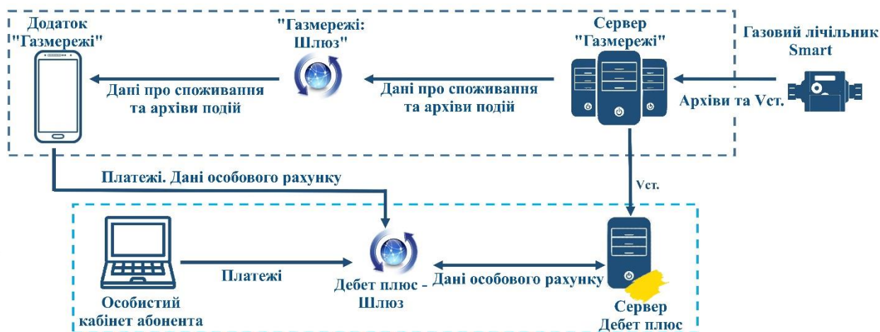
Рис. 5.3. Схеми передачі даних до Інтелектуальної системи обліку газу
