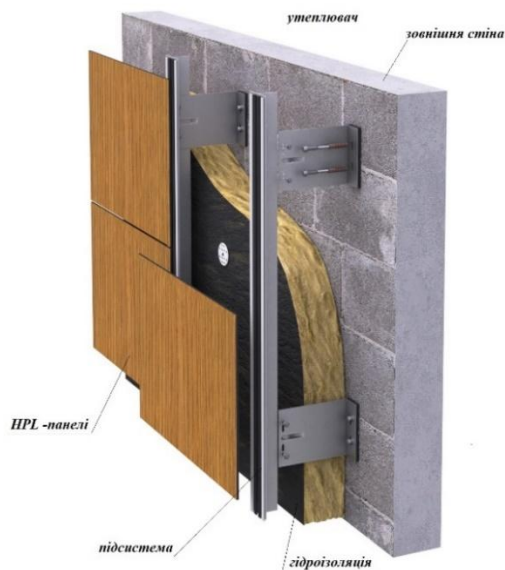
Рис.4.7 Оздоблення фасадів : навісні вентильовані фасади.
