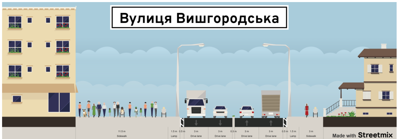
Рис. 1.12. Типовий поперечний профіль (Розріз 1-3) вул. Вишгородська.
