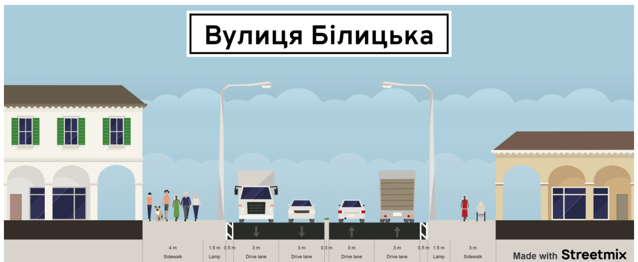
Рис. 2.7. Запроектований поперечний профіль (Розріз 2) вулиці Білицька.
