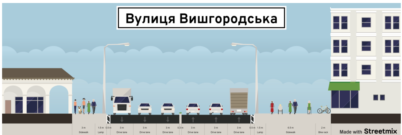
Рис. 1.13. Типовий поперечний профіль (Розріз 3-1) вул. Вишгородська.
