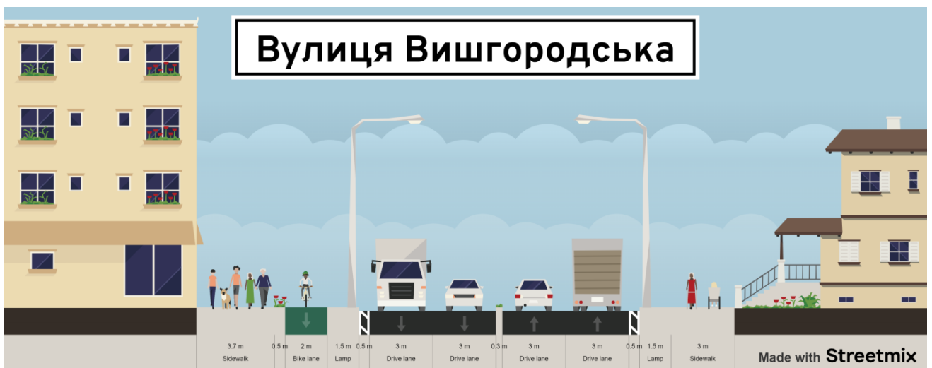
Рис. 2.6. Запроектований поперечний профіль (Розріз 1-3) вулиці Вишгородська.
