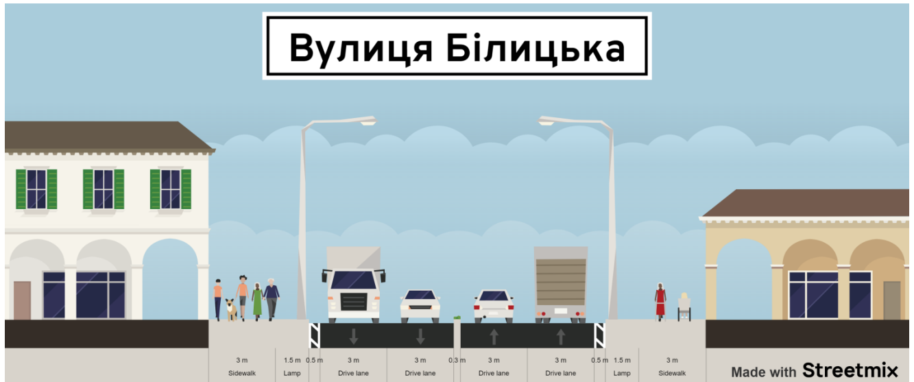
Рис. 1.14. Типовий поперечний профіль (Розріз 2) вулиця Білицька.
