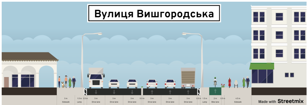
Рис. 2.8. Запроектований поперечний профіль (Розріз 3-1) вулиці Вишгородська.
