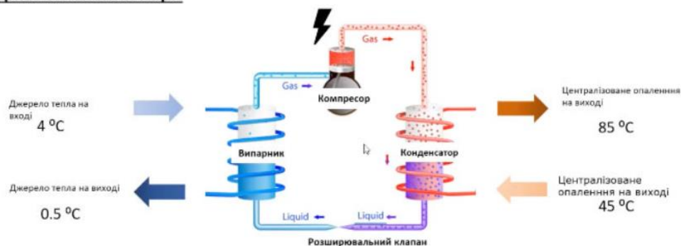
Рис.7.2 – Технологія теплового насосу
