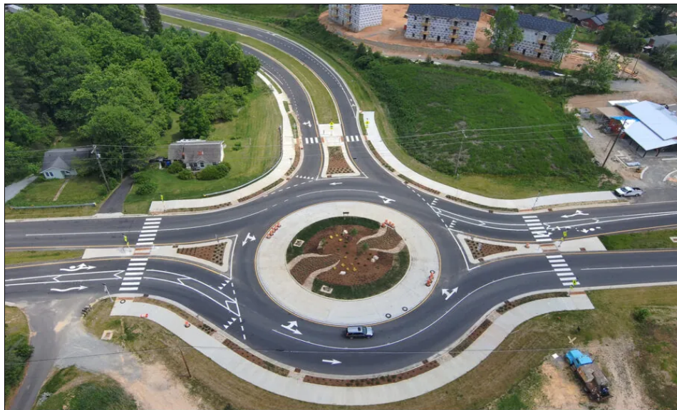
Рис. 16 Приклад облаштування турбокіля з використанням острівців безпеки
