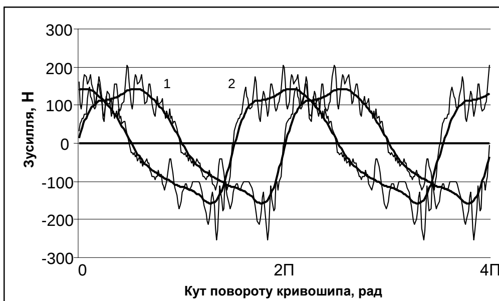
Рис. 8. Графік зміни зусилля в шатунах в робочому режимі
