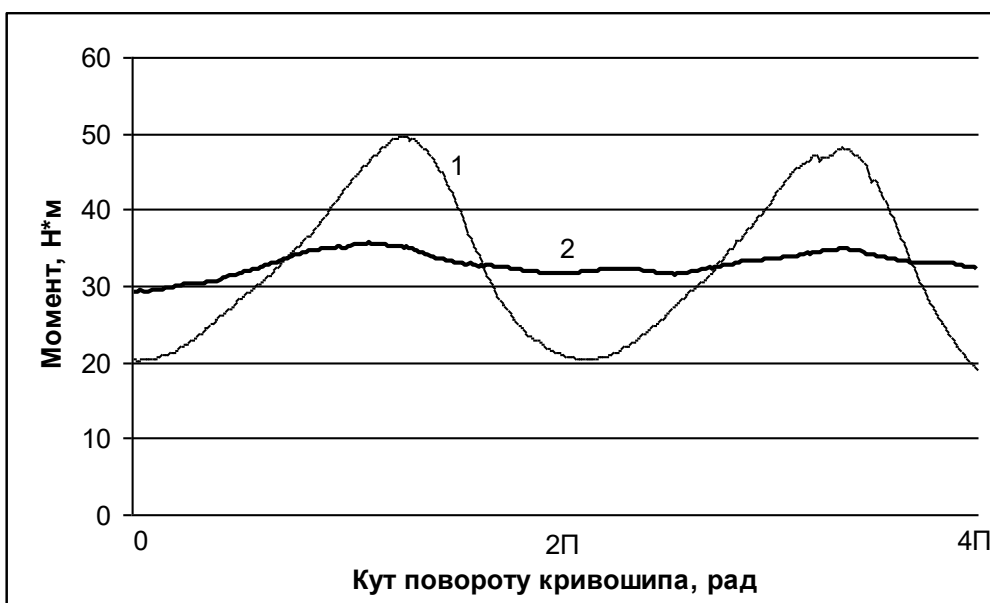
Рис. 10. Графіки зміни крутного моменту на привідному валу установки в холостому режимі з одним формувальним візком (1) та з двома візками (2)
