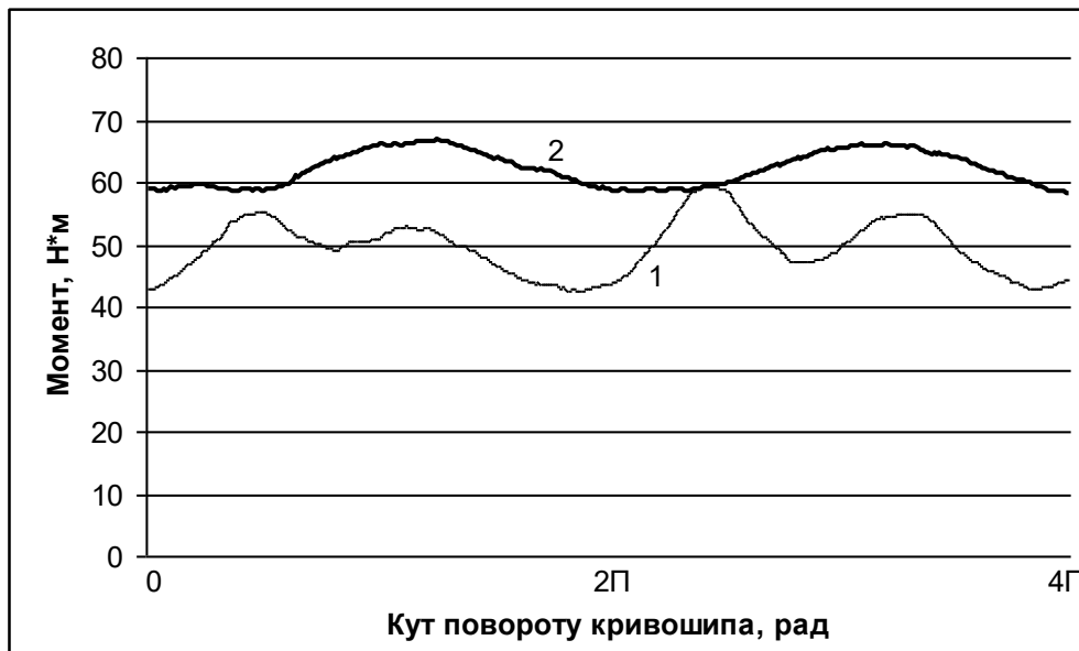
Рис. 11. Графіки зміни крутного моменту на привідному валу установки в робочому режимі з одним формувальним візком (1) та з двома візками (2)
