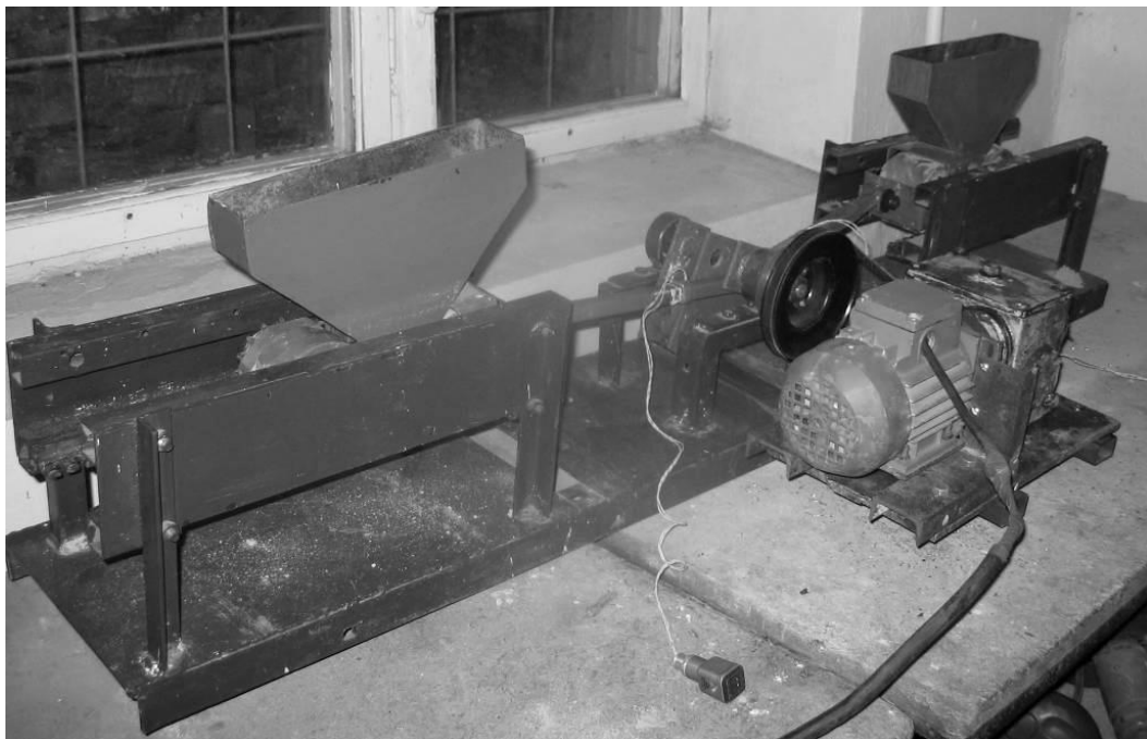
Рис. 1. Фізична модель роlikової формувальної установки з рекупераційним приводом
