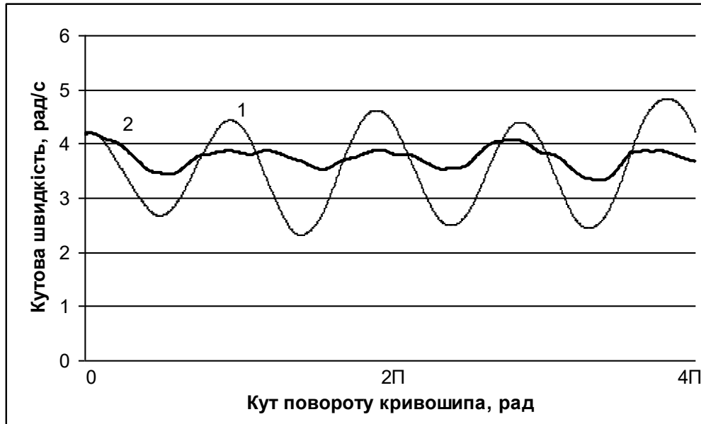
Рис. 2. Графіки зміни кутової швидкості привідного вала установки в холостому режимі з одним формувальним візком (1) та з двома візками (2)
