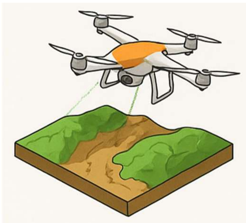
Рис. 1.6. Визначення об'ємів земляних робіт за допомогою БПЛА та фотограмметричного методу
