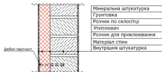
Рисунок 1. Технологія влаштування фасаду з оздобленням штукатуркою [7]
