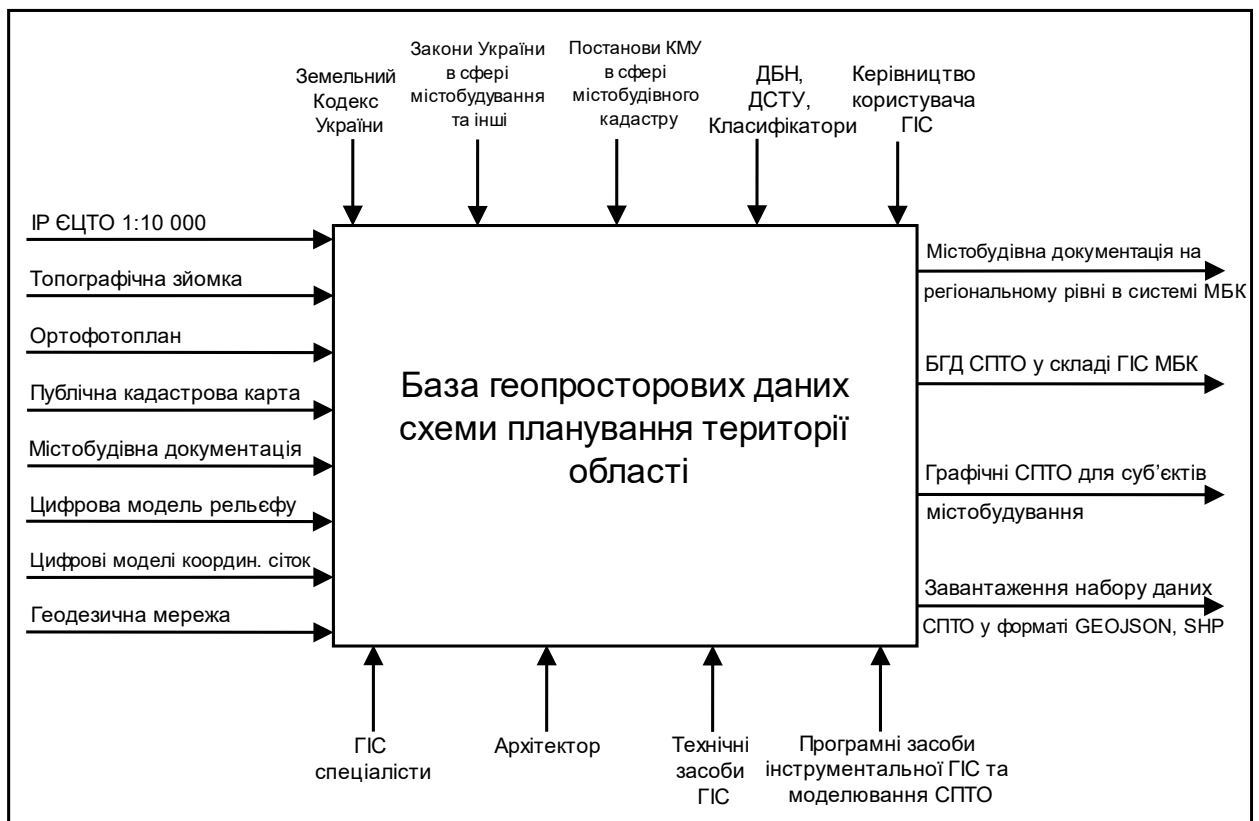
Рис. 3.1. Технологічна схема бази геопросторових даних схеми планування території області
