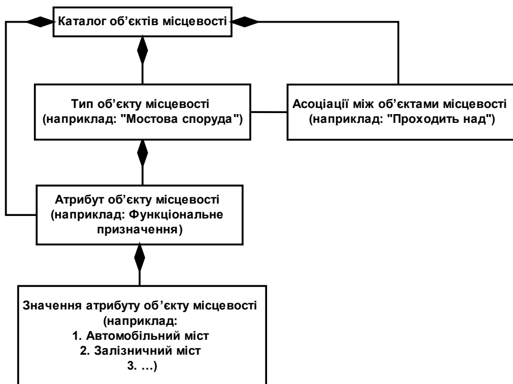
Рис. 2.5. Принципова схема каталогу об'єктів місцевості за ISO 19110
