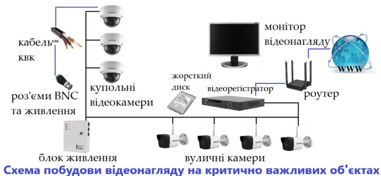
Рис. 4.2 Схема побудови відеонагляду на критично важливих об'єктах
