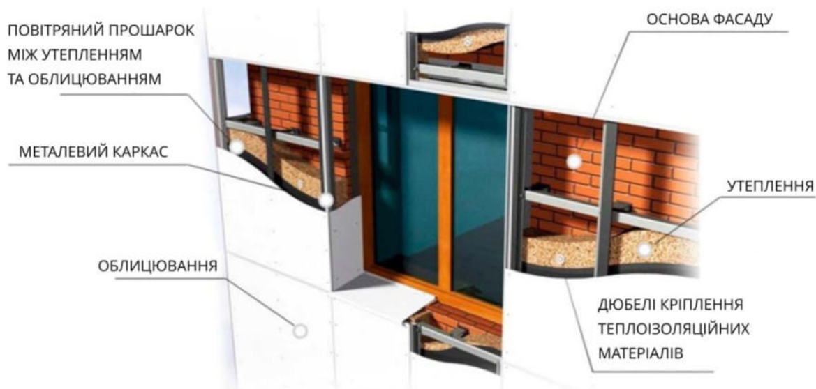
Рис 6.5. Схема вентильованого фасаду
