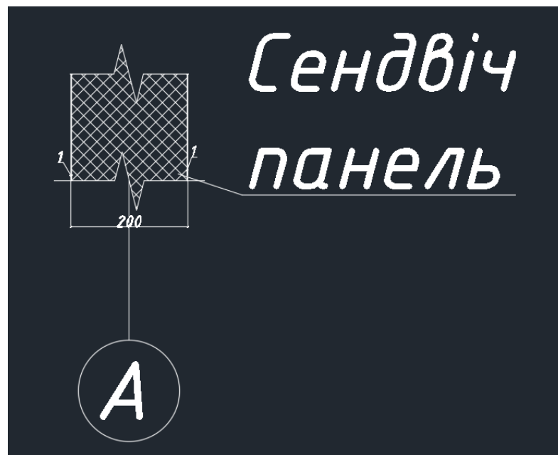
Рис. 1 Розрахункова схема зовнішньої стіни
