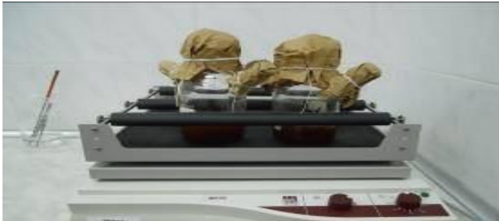
Рис.3.2.8. Колби на горизонтальному шейкері
