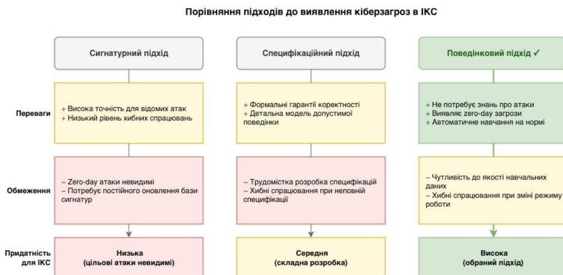
Рисунок 3.1 – Порівняння підходів до виявлення кіберзагроз в промислових системах керування
